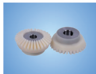
Зъбни колела от PA 12 G със стоманена сърцевина модул 1.5
